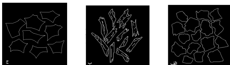
شکل ۱۱. چگونگی شکست سنگ‌ها در سنگ‌شکن (الف). دولومیت، ب. گنایس، ج. گرانیت و دیوریت)
